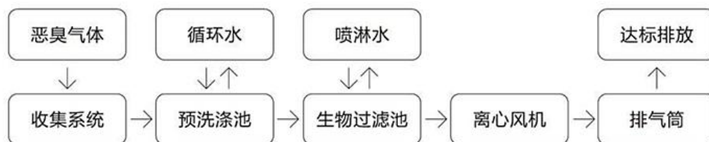
图 6.2-3 生物除臭系统工艺流程
